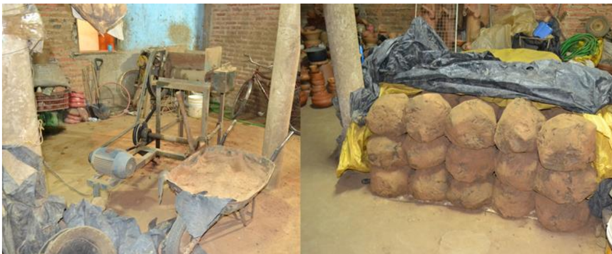
Fig. 2. A esquerda observasse os equipamentos utilizados para o tratamento da argila que e trazida das covas, observando o equipamento se nota uma dupla de cilindros que prensam a argila que passada pelo equipamento deixando visíveis outros materiais que não sejam inerentes à composição da argila.
