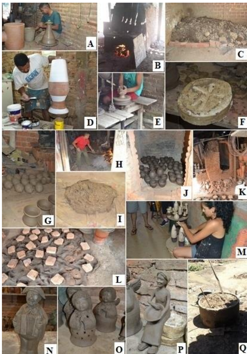
Fig. 1 A, E. Utilização do torno, no momento da produção. O artesão utiliza apenas as mãos e equipamentos rústicos como pedaços de madeira ou plástico para dar a forma ao artesanato. B. Queima das peças, o forno funciona a base de madeira que são obtidas por terceirizados, os membros que comercializam as madeiras para a queima não são os artesãos. C, Q e I. Processo de reutilização da argila no qual seca e depois será molhada até que ganhem uma plasticidade adequada para que possa ser novamente modelada. D e M. Técnicas de pintura, a última etapa antes da comercialização do produto, sendo confeccionado normalmente pelas mulheres, o que não impede que seja realizada por homens. F Fôrma utilizada para a produção de peças com gesso. G. Artesanato de cofres em forma de porquinhos e vasos expostos para secar. H. Queimador – especialista nas diversas etapas da queima. J. Peças organizadas no forno e preparadas para a queima. K. Forno construído a base de tijolos e feito de forma manual, o tamanho do forno varia de acordo com a necessidade de cada loja. L. Tratamento utilizado por alguns artesãos para melhorar a plasticidade da argila. N e P. Figuras características da cultura local. O. Detalhes feitos após a primeira secagem, cortes e furos.
