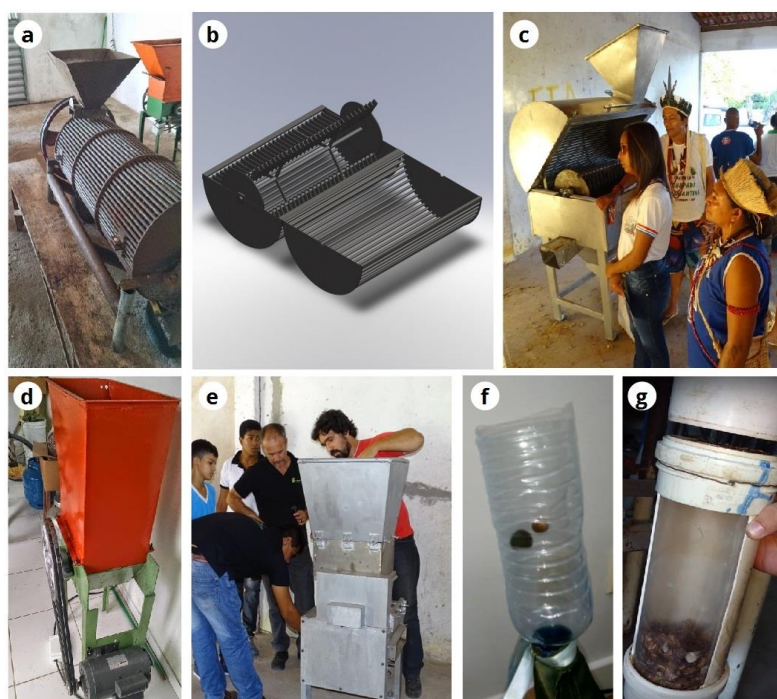
Figura 2. Protótipos e máquinas beneficiadoras de licuri: máquina despeladeira – original (a) e protótipo (b, c) testado com sucesso na 9ª Festa do Licuri (junho 2016, Quixabeira – BA); máquina quebradeira – original (d) (Comunidade de Caixão, Cansanção – BA) e protótipo (e) testados com alunos da EFA Jaboticaba (junho 2016, Quixabeira – BA); testes de separação a seco (f, g).
